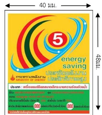
ตัวอย่าง ฉลากประหยัดพลังงานประสิทธิภาพสูง สำหรับ เครื่องยนต์ดีเซลขนาดเล็กระบายความร้อนด้วยน้ำ
