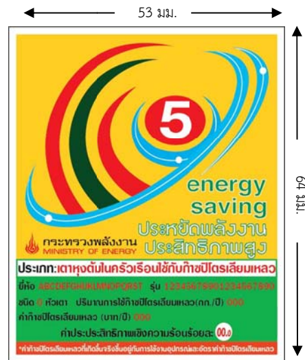
ตัวอย่าง ฉลากประหยัดพลังงานประสิทธิภาพสูง สำหรับเตาทุงต้มในครัวเรือนใช้กับก๊าซปิโตรเลียมเหลว
